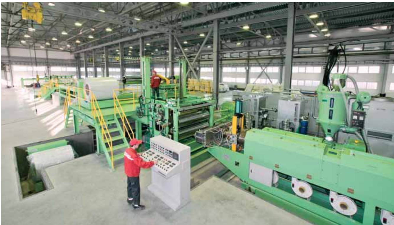
Высокотехнологичная линия по производству огнестойких алюминиевых композитных панелей Краспан-А1, завод КРАСПАН,
