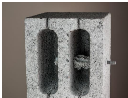
Фото 1. Установка химического анкера в пустотелых блоках
