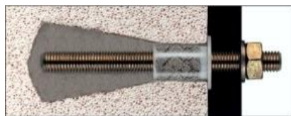
Рис. 3. Установка химического анкера в ячеистом бетоне
