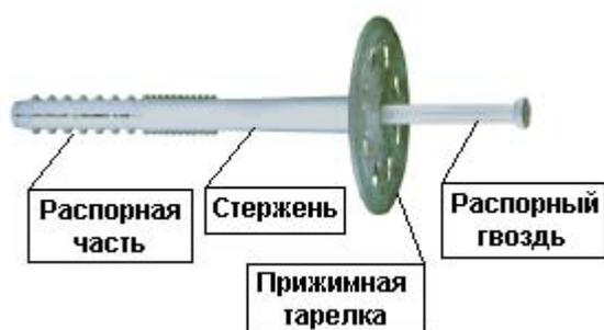
Основу крепежной системы **фасадной термоизоляции** составляет особый удлиненный распорный дюбель, имеющий широкую головку в виде прижимного диска (тарелки) (Рис.3.5). Возможна и составная конструкция: прижимной диск, стержень, распорный дюбель. Диаметр прижимного диска – от 45 до 90 мм, но наиболее
