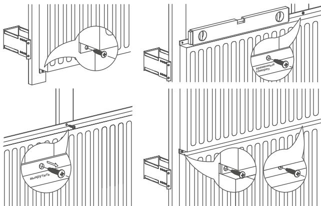
Установить кассету по уровню и закрепить ее снизу к направляющим специальными саморезами Ø4,2 мм в существующие в полке отверстия, закрутив 1 саморез сверху по центру. При монтаже следующей кассеты необходимо выкрутить верхний саморез, установить сверху кассету, совместив ее с нижней, и закрепить саморезами Ø4,2 мм в существующие в полке отверстия (по 1 саморезу в каждый профиль).
