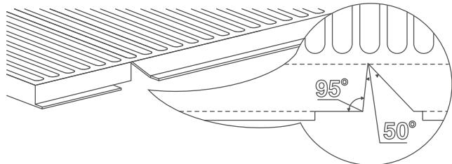
Наружный угол выполняется путем надреза верхней и нижней полок, а также загибом кассеты на станке гибки КраспанМеталлТекс. Место перехлеста полок необходимо скрепить заклепкой K 8.H.
