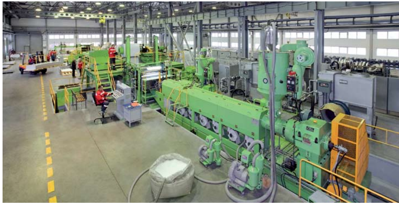
Завод «КРАСПАН». Единственная в России линия по выпуску огнестойких стальных композитных панелей
