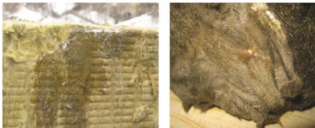
Фото 1. Переувлажнение утеплителя ведет к его промерзанию и деструкции
