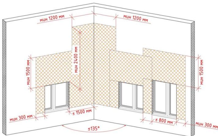
Рис. 2. Зоны локальной теплоизоляции кронштейнов
