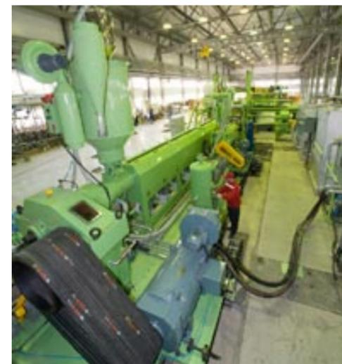
Завод КРАСПАН. Высокотехнологичная линия по производству огнестойких АКП Краспан-AL. Сердечник огнестойкой фасадной панели Краспан-AL на 75% (в перспективе – до 85%) состоит из минералов – этого позволяет добиться мощный экструдер новой линии завода КРАСПАН, аналога которой нет в России.
