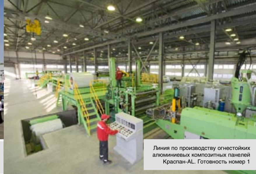
Линия по производству огнестойких алюминиевых композитных панелей Краспан-AL. Готовность номер 1
